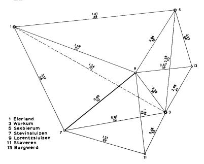
Fig. 2.1.7. The standard deviations  $\ln s_{ij}$  and  $s_{ij}$ .
