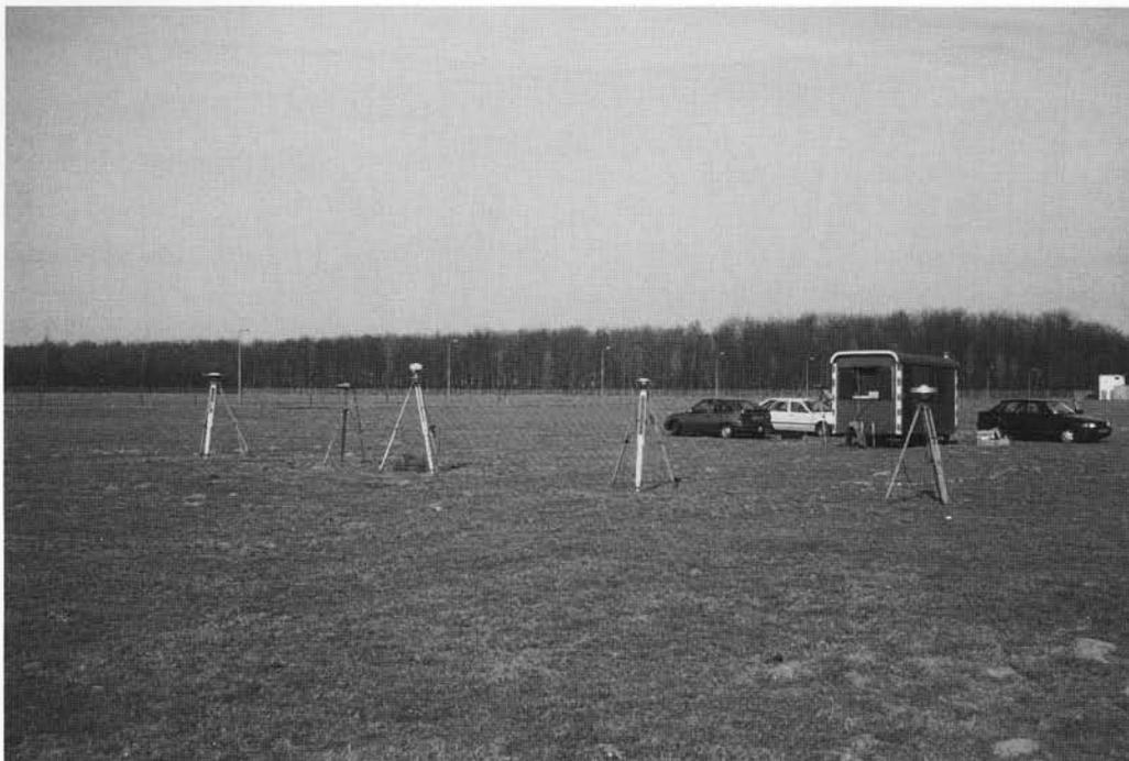
Array of GPS-antennas + antenna spectrum analyser.
