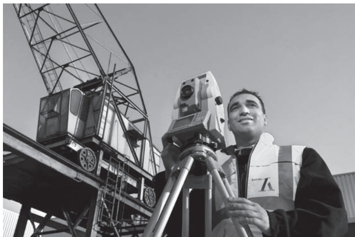
De kadastrale landmeter met de tachymeter aan het werk.
