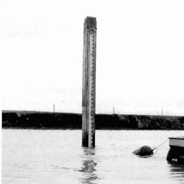
5. De zichtbare verticale geometrische infrastructuur. De waterhoogte kan direct ten opzichte van het Normaal Amsterdams Peil (NAP) worden afgelezen.
