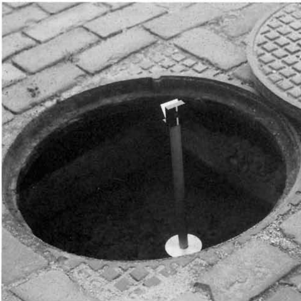
38. De onzichtbare verticale geometrische infrastructuur. Een ondergronds NAP-hoogtemerk.
