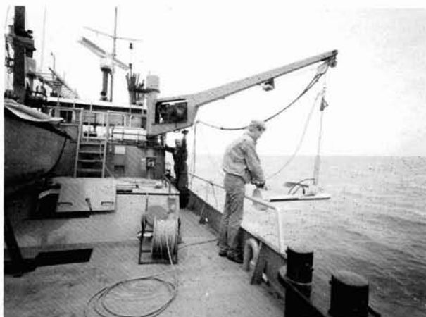
8. Hydrografisch opnemen. Onder water wordt via geluidsgolven gemeten.
