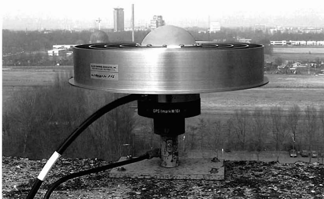
Dorne Margolin GPS-antenne van het AGRS.NL-referentiestation op het gebouw van de Afdeling Geodesie, TU Delft te Delft (foto: A.B. Smits, TU Delft).
