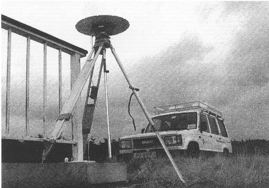
GPS-meting op een GPS-kernetpunt.
