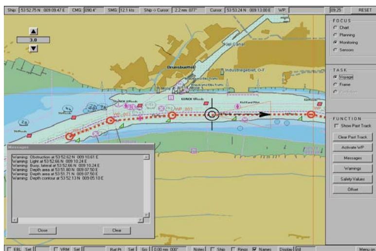
Ontwerp voor het Inland ECDIS (Electronic Chart Display and Information System).
