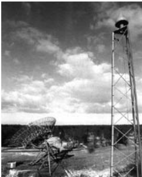
De antenne van het Actief GPS Referentie Systeem (AGRS) op de Radiosterrenwacht te Westerbork. Foto: H.J. Stiepel, ASTRON.
