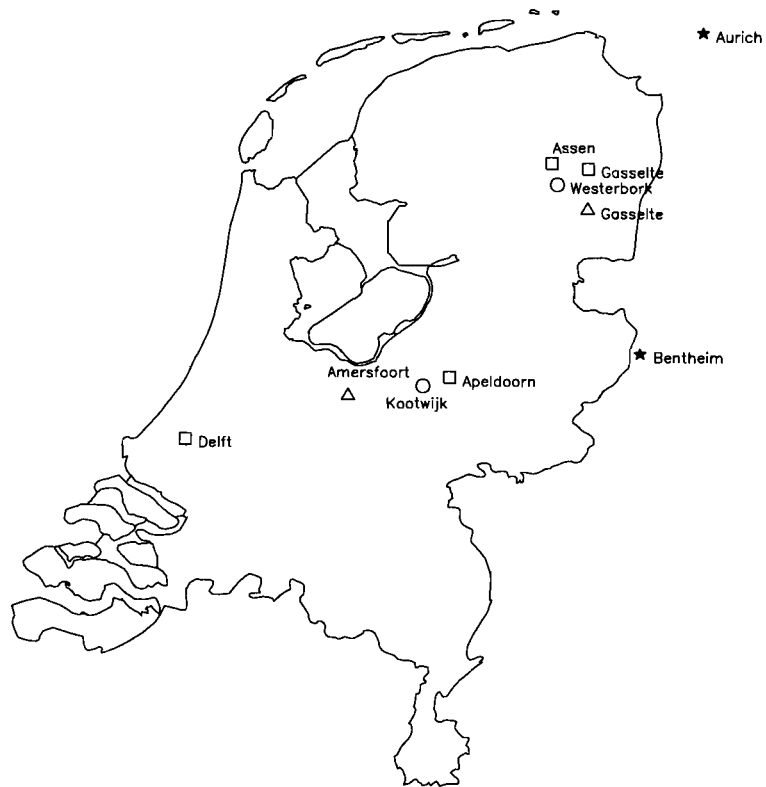
Figuur 4.1: Stations van het NED91 netwerk, een vierkantje is een TUD punt, een driehoekje een RWS punt, een sterretje is een punt in het buitenland en een rondje is een absoluut punt.
