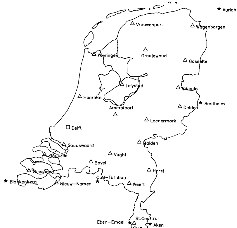
Figuur 3.1: Stations van het RWS netwerk, een vierkantje is een TUD punt, een driehoekje een RWS punt en een sterretje is een punt in het buitenland.
