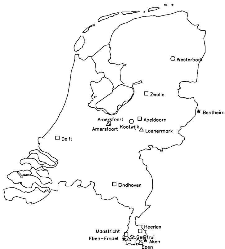
Figuur 4.2: Stations van het NED93 netwerk, een vierkantje is een TUD punt, een driehoekje een RWS punt, een sterretje is een punt in het buitenland en een rondje is een absoluut punt.
