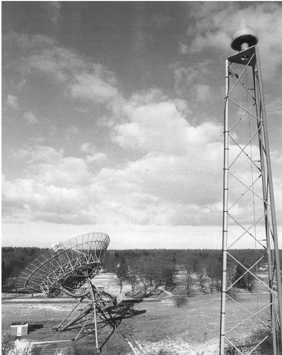
De GPS-antenne van het AGRS.NL (rechts) en één van de antennes van de syntheseradiotelescoop in Westerbork (foto: H.J. Stiepel, Stichting ASTRON).
